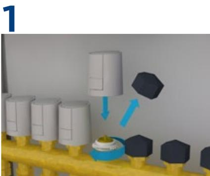
Отвинтите колпачки от регуляторов, навинтите переходник для клапана, установите привод клапана!
